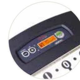
Integriertes Bedienteil mit Anzeige im Wobbel-Auswahlmodus
